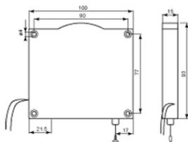
Le 471-CSA est détecteur d'ouverture de volet roulant qui s'installe dans le coffrage de celui-ci. Une corde en nylon est fixée sur la partie mobile du volet. Lorsque celui-ci bouge la corde s'enroule ou se déroule dans le détecteur est provoqué des ouvertures rapides du contact de sortie.
